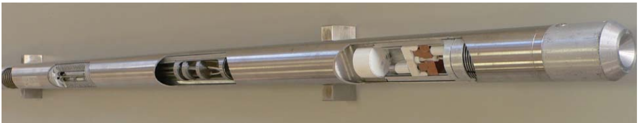
図1 照射用キャプセルのカットモデル
