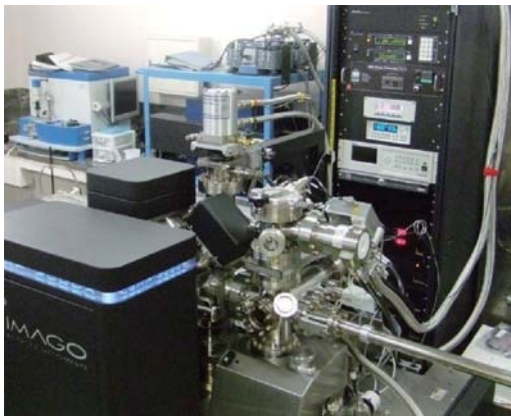
図2 3次元アトムプローブ（紫外レーザー付き質量補正型）S
